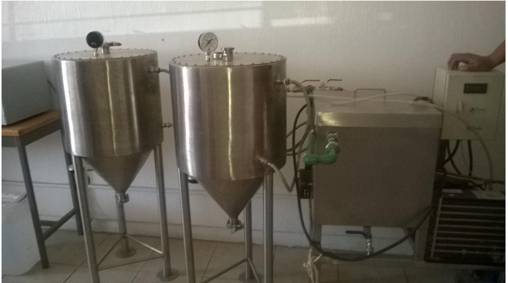
Figura 1. Reactores para para la producción de biodiesel mediante aceites vegetales .
